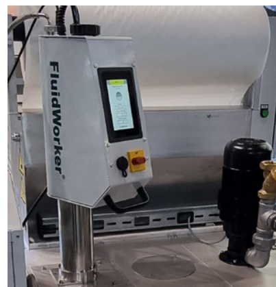
FluidWorker® 50 инсталиран на резервоар за охлаждаща течност
